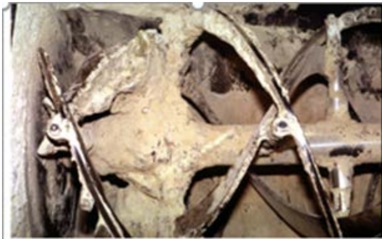
Acumulación de producto en mezcladora
